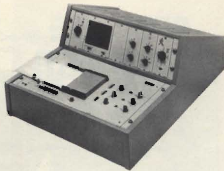
Fig. 14 - Elettromedicali di produzione nazionale: un'apparecchiatura pluricanale predisposta per elettrocardiografia, fonocardiografia e sfimografia della REMCO ITALIA, una ditta con oltre 25 anni di esperienza in questo campo.
