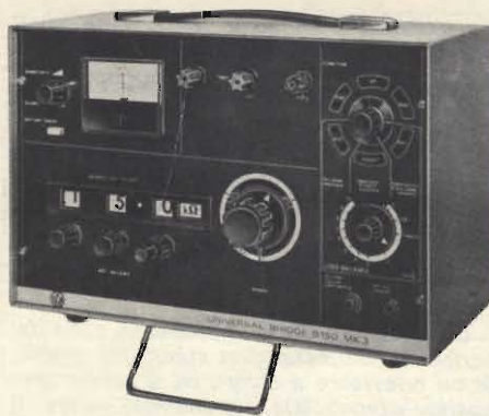
Fig. 16 - Ponte universale di misura, per misure di capacitanza, induttanza e resistenza adatto per laboratori medi, modello B/150/3 della AVO.
