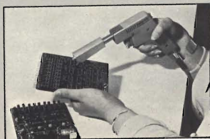
La forma è anatomicamente corretta per operare sui C.S. posti in piano.
